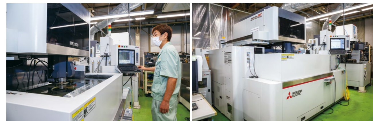
通常の「MP2400」でも三菱電機指定加工±2ミクロンの精度保証のある高精度機であるが、その精度保証機の機械の組立をさらに高精度に作り込む超高精度仕様の特殊仕様。超硬ワークを水の加工液の中で長時間加工するためのオプションA.S.C回路を付けており、超硬ワーク加工面が美しく仕上がるのもポイント。
