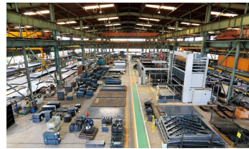
鋼板の溶断を中心に行う福岡工場内部。中央右にファイバレーザ加工機「GX-F60」と自動仕分けシステム「ASTES4」が設置されている。その左に積み重ねられているのは「GX-F60」+「ASTES4」で加工した製品だ。
