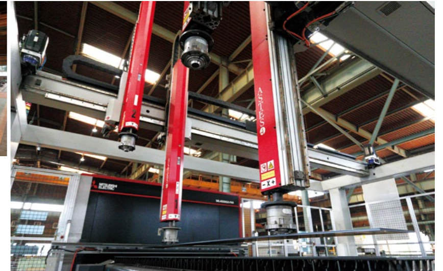
「GX-F60」と「ASTES4」の組み合わせでレーザ切断の自動化が実現され、作業の効率化・省人化に加えて作業者の負荷軽減も達成した。
