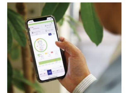
「iQ Care Remote4U」を活用し、自動化の一連の工程や稼働状況などを遠隔で把握できるように。駒谷氏は日頃は事務所のPC画面で確認するが、社外からスマートフォンでチェックすることもあるそうだ。
