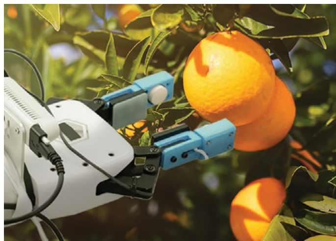
遠隔操作で、果実をつぶすことなく、人と同じ適度な力でもぎとるロボット。現実になる日が近づいています。
