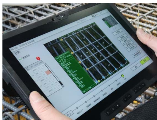
道路工事における「AI 配筋検査システム」を用いた検査の様子
