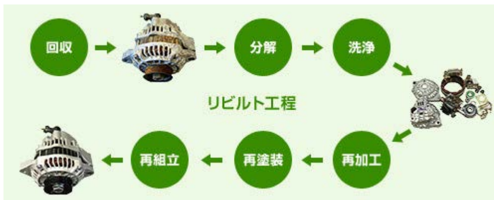
リビルト工程
