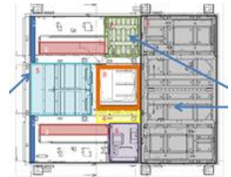
箱枠を上面から見た図 (水密試験のエリアを示す)
