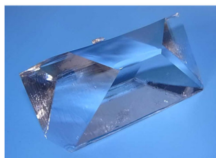
図 非線形光学結晶CLBOと、本発明により実現した波長213nmの高出力深紫外レーザー
