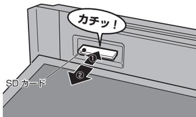
SDカードが飛び出し、抜き取る状態になります。ゆっくりと抜いてください。
