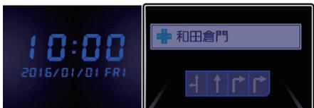
前方の交差点名称およびレーン情報を表示します。
