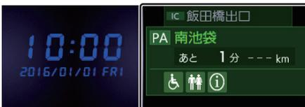
前方のSAやPA、JCT、IC、スマートICの施設名称、距離、所要時間、施設情報アイコン、次の施設名称を表示します。
