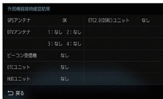
本機に接続されている外部機器の接続状態を表示します。
