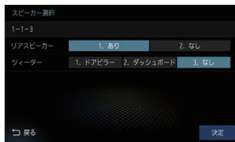
「システム構成図」(P41)を確認し、実際に取り付けているスピーカーシステムどおりの設定を行ってください。
