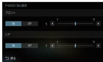
レベルを 10 方向へ補正すると低音の量感、厚みを増強できます。
