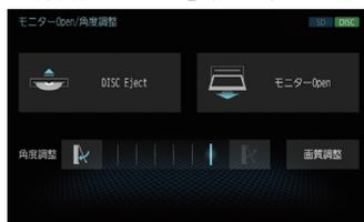
パネルが開き、本機からディスクが排出されますので、ディスクを抜き取ってください。
