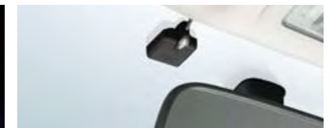
ルームミラー裏のフロントガラスに ※アンテナ部をフロントガラスに取付ける際は、ルームミラーの陰で運転者の視界の妨げにならない場所に取付けてください。
