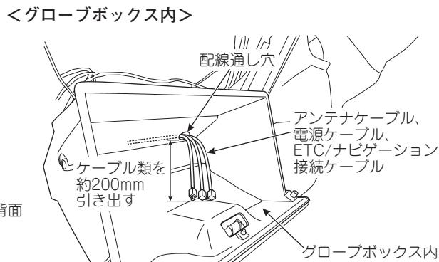
※あらかじめ開口する中心点にキリなどで溝穴を設けてφ16mmのホールソーで開口します。
