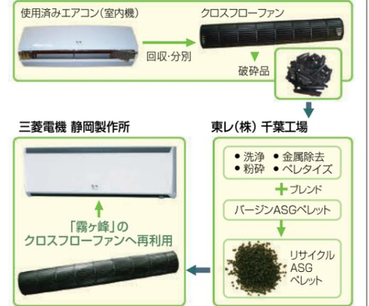
エアコン室内機の送風機「クロスフローファン」はASG(ガラス繊維強化樹脂)製で、この素材は室内機全プラスチックの13%を占めます(重量比率)。従来、このファンは異物付着やガラス繊維折損などが多くリサイクルが困難とされてきました。当社は東レ(株)と共同で、リサイクルセンターで分別されたASGを再生し、再びファンの材料として利用する業界初の自己循環型リサイクル技術を開発。パージン材とほぼ同等の物性を確保し、2005年2月末から静岡製作所で量産しています。
