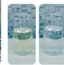
2005年の愛知万博では、NEDO(独立行政法人 新エネルギー・産業技術総合開発機構)との共同研究による「オゾンを用いた促進酸化処理による廃水リサイクル」の実験を行いました。会場内の下水本管から取水した一般廃水を処理し、トイレ用水や屋根散水に再使用するシステムで実用化・製品化に向けた有効性を実証しました。
