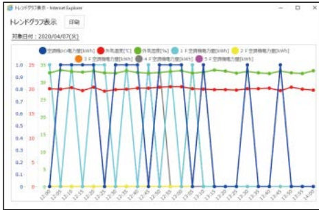
最大8点までの計測データ(電力、電流、電圧など)を表示
