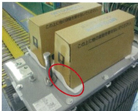
クッション材取付け状況(保護用ダンボール側に固定)
