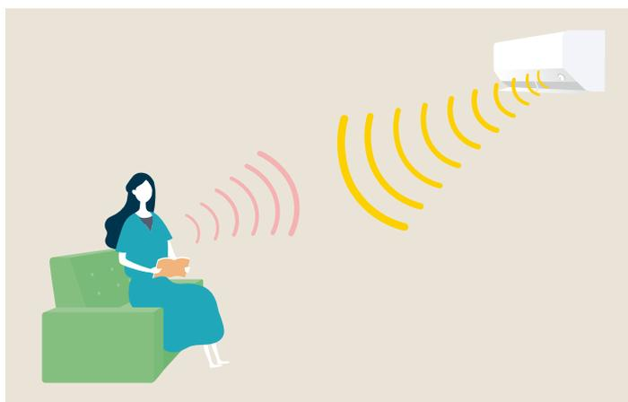
センサーから準ミリ波(24GHz)を発して、人からの反射波を捉え、ドップラー効果によって脈を取得します。
