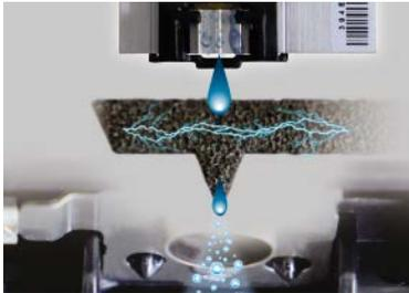
空気中の水分に高電圧をかけて、極小の水の微粒子に変える。
