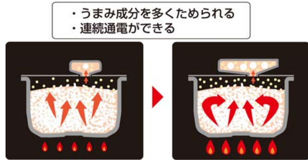
図 2. カートリッジ大容量化による連続大沸騰のイメージ
