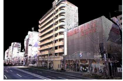
事例4(今回)：「ビル外観」 長距離・高密度レーザー一点群でビルの細部まで鮮明に表示
