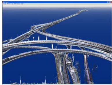
事例2(従来)：高速道路 標準レーザー一点群のカラー化で立体交差を表示
