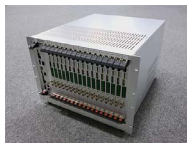
図 2 SHV 用 HEVC 符号化装置外観 [幅 431×奥行 496×高さ 312 mm]
