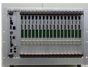
図 2 SHV 用 HEVC 符号化装置外観 [幅 431×奥行 496×高さ 312 mm]
