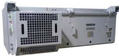
大容量フル SiC パワーモジュール適用 鉄道車両用インバーター装置
