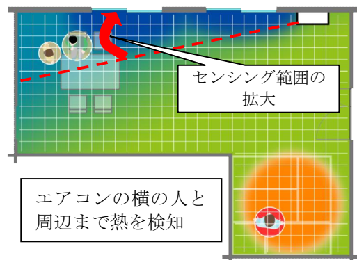
図 2 2015 年度モデル「ムーブアイ極」動作とセンシングイメージ
