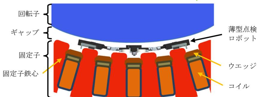
図 2. 発電機部分断面図
