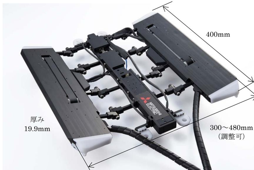
発電機用薄型点検ロボット
