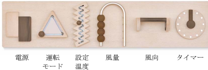
図1 空調機器を例にしたリモコンの試作機
