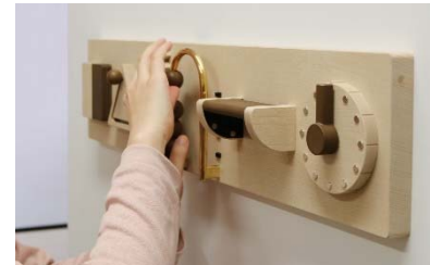
図2 ボールを動かして風量を調節している様子
