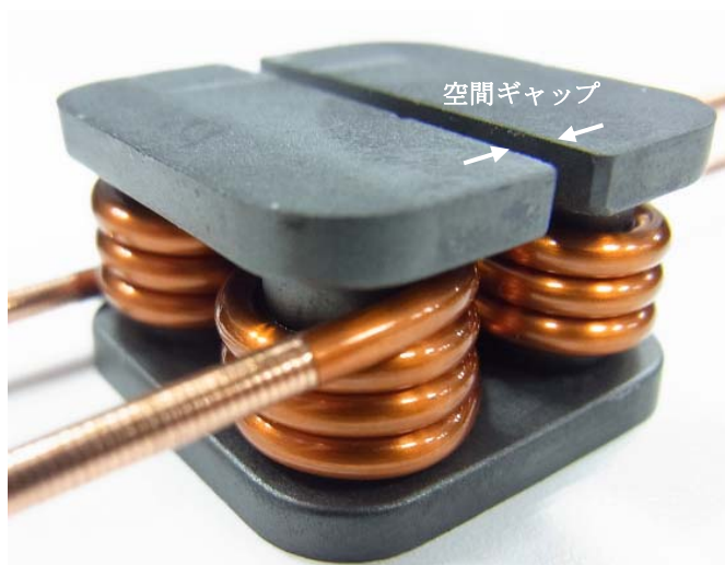
図2 今回開発したデュアルモードチョークの外観
