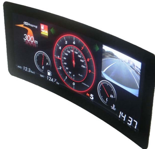
今回開発した技術を適用した曲面カラーTFT 液晶モジュール（曲率半径 800mm）
