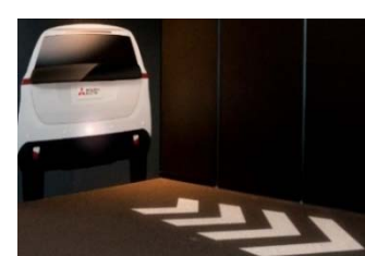
光のアニメーションで車の後退を 知らせて注意喚起する表示技術
