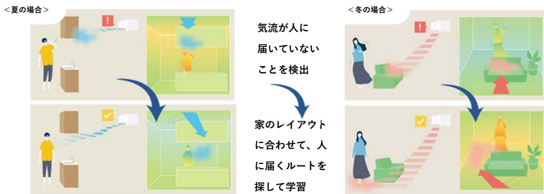
図4 「ムーブアイ mirA.I.+」による気流を自動調節するイメージ
