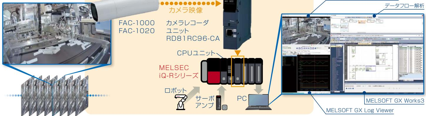
カメラレコーダユニットで記録した装置の制御データとカメラ映像を
