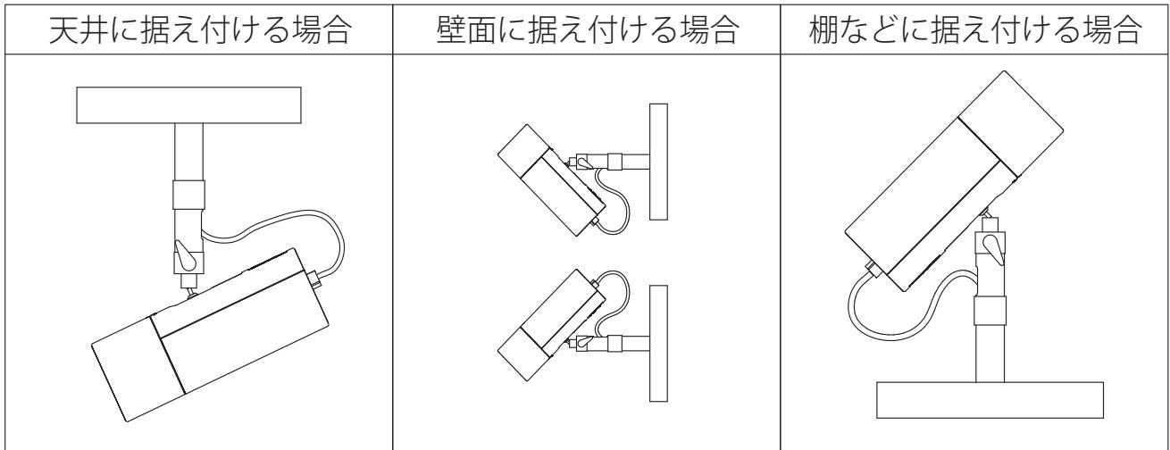
※棚に据え付けるなど逆さにして設置した場合は、映像を適切な向きにするために取扱説明書の「8.6.4.f ビデオ調整」の項をご参照ください。
