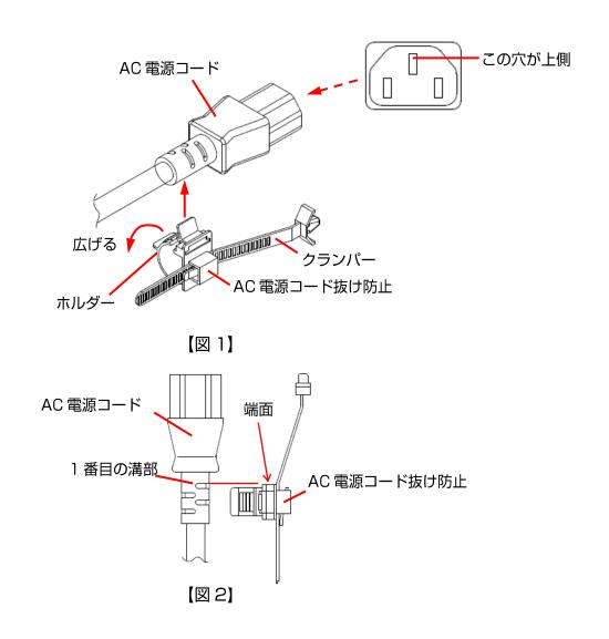
(2) 図3、図4を参照し、クランパーレバーを押上げながらクランパーを矢印方向に動かし、AC電源コードの先端に合わせ、ホルダーを矢印方向に押し込んでロックします。
