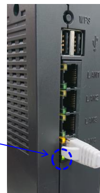
AS-2000GNS3-1WW 背面 LAN ケーブル接続例
