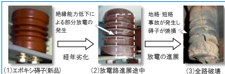
図-1 エポキシ碍子(非修理系部位)の劣化過程
