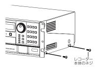
3. 底面にある脚を取りはずす。 ネジをはずし、脚を取りはずしてください。
