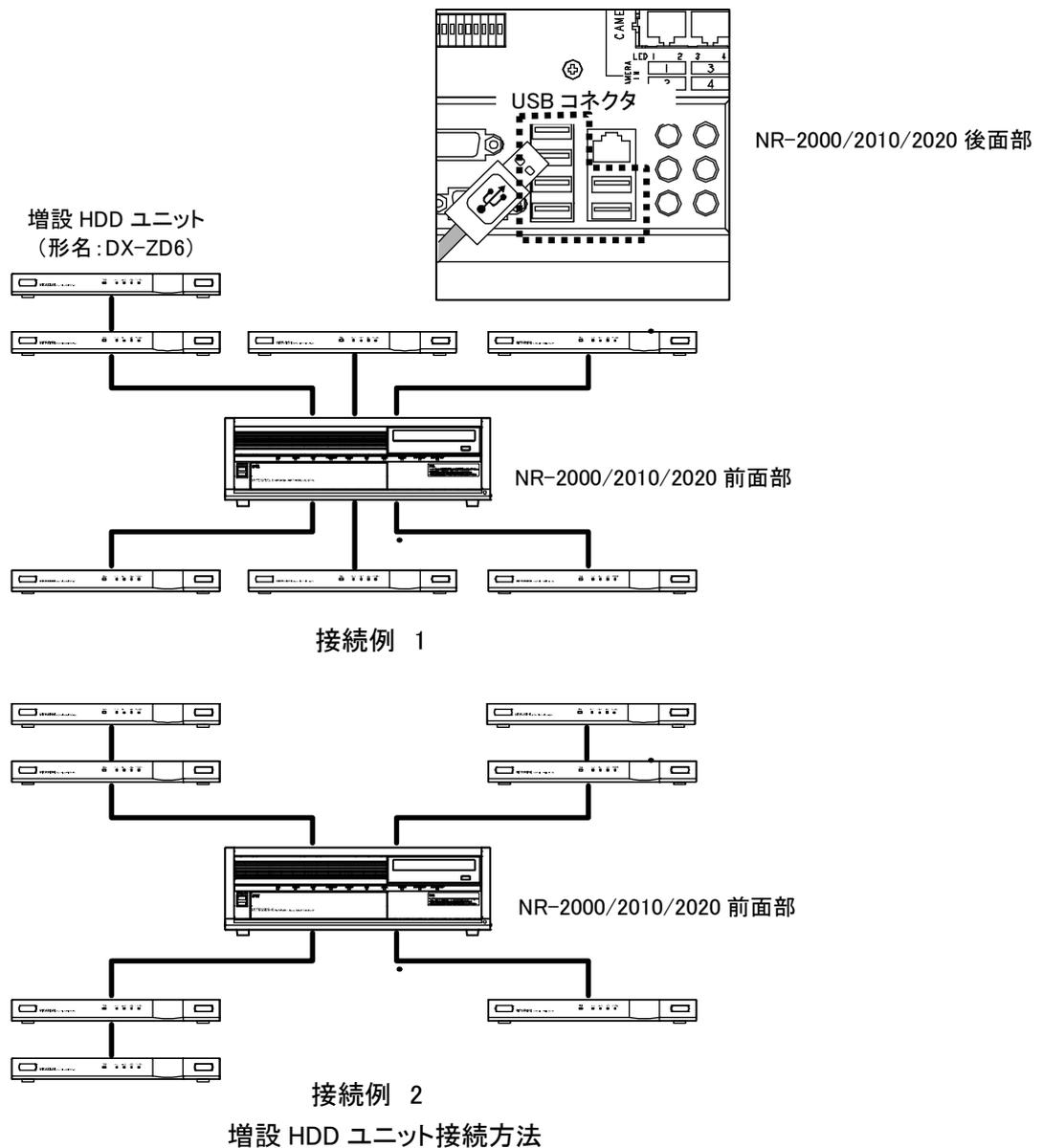
増設 HDD ユニートをシリアルバス(USB)ケーブルを使用して、本レコーダー後面部の USB コネクタに接続してください。増設 HDD ユニスは、最大 7 台、7TB まで増設できます。
