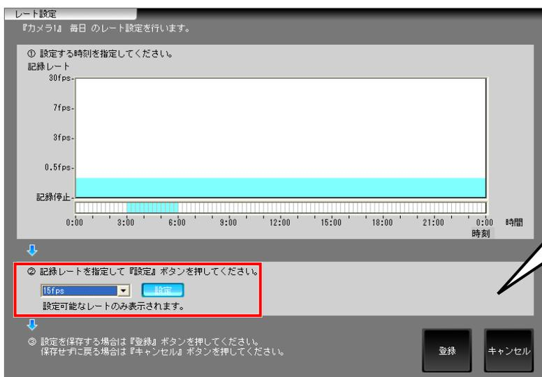
手順 3: ボタンから記録レートを選択し、設定ボタンを押します。上記の手順 2 で指定した時刻の範囲に記録レートが設定されます。
