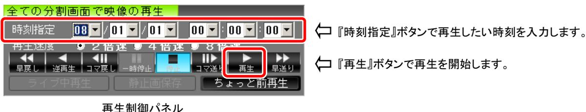
このとき、「再生制御」パネルは再生中表示に切替わります。緑色の枠が表示され再生中であることを示します。再生を終了するときやコマ送りなどをする場合には、それぞれのボタンを押して操作します。
