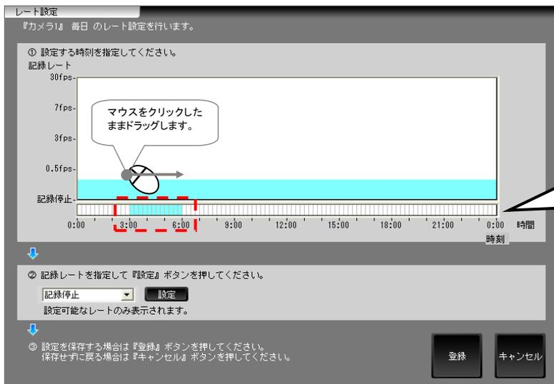
手順 2: 手順 1 で指定した開始点からマウスのドラッグ操作により、指定する時刻の終了点まで移動しマウスの左クリックをはずします。
