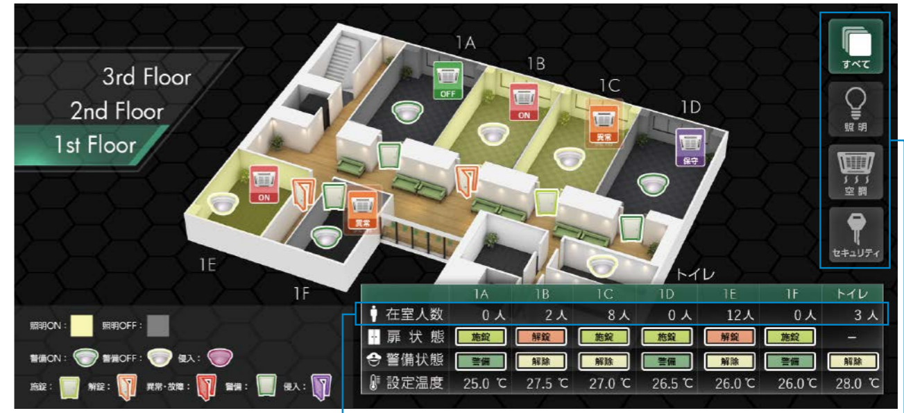
設備や入退室管理の監視・制御画面例
