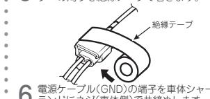
6 電源ケーブル(GND)の端子を車体シャーシグランドにネジ(車体側)で共締めします。
