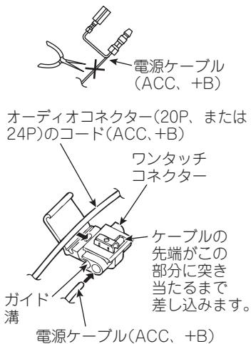
3. コード、ケーブルがワンタッチコネクターから抜けないようにペンチなどでエレメントを押し込みます。
