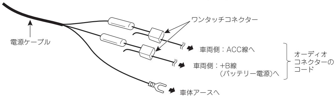
1. ETC2.0車載器本体側の電源ケーブル(ACC、+B)のギボシ端子を切り取ります。
