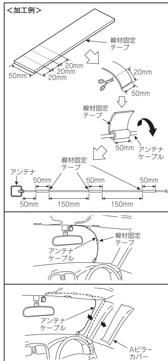
**3** アンテナケーブルをフロントガラスと天井の内張りの隙間に押し込みます。
