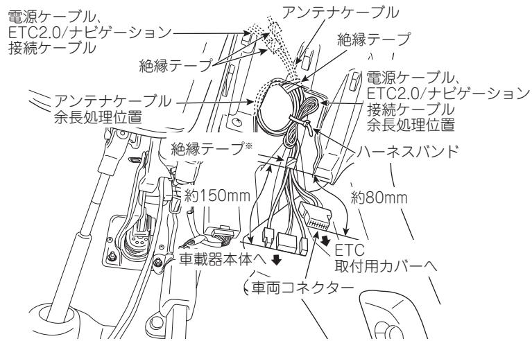
\* 車両コネクターから約80mmの位置でアンテナケーブル、電源ケーブル、ETC2.0/ナビゲーション接続ケーブルを絶縁テープで固定します。
