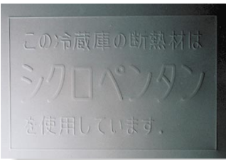
冷蔵庫背面の銘板
