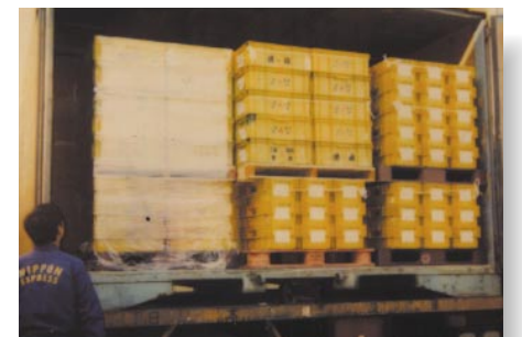
5t鉄道コンテナ積載状況
