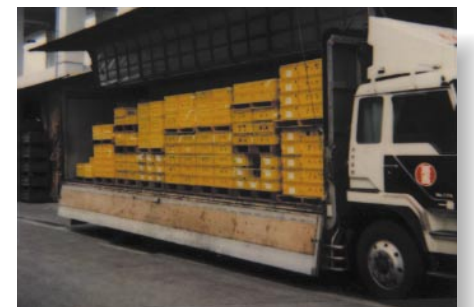
10tトラック積載状況
