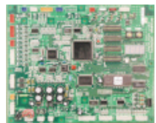
鉛フリーはんだを使用した基板（冷蔵庫）
