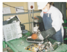
手解体ライン
