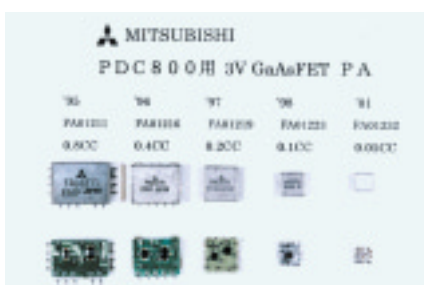
携帯電話用高出力アンプ(高周波デバイス)での省資源化
