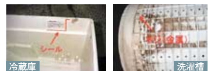
プラスチック部材に付着する異物の例
