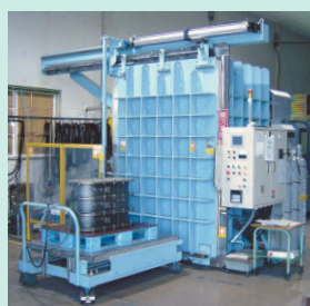
Heリーク試験装置《概要》 対象製品 / ガス絶縁開閉装置 装置寸法(m) / W3.8×D2.0×H3.0 試験用ガス / Heガス( \text{SF}_6 ガス不要) リーク感度 / 10^{-8}(\text{Pa} \cdot \text{m}^3/\text{sec})
