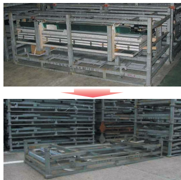
スチール製の通い容器は、使用時には収納する昇降機の部材に合わせて組み立て、現地作業終了後折りたたんで積段し、事業所に返送する。
