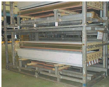
スチール製の通い容器は、使用時には収納する昇降機の部材に合わせて組み立て、現地作業終了後折りたたんで積段し、事業所に返送する。
