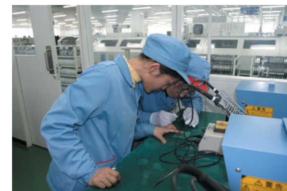
▲MDIでは基板に使うはんだの鉛フリー化を進めている。鉛フリーのはんだ付けには技術が必要なため、熟練者は後輩の指導にもあたる。
