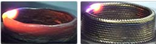
加工中の様子 左：連続造形（従来） 右：点造形（新開発）
