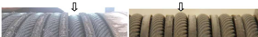
図2 複数の溝間に著しい摩耗差の例(矢印部)
