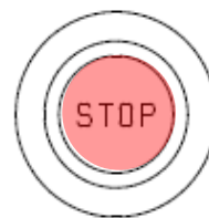
非常停止ボタン
