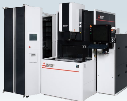
高精度形彫放電加工機 SV8P + EDCHANGE SLIM
