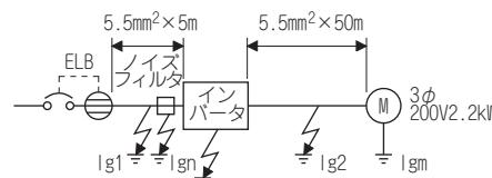
(a) 漏電ブレーカ（ELB）は、インバータの入力側に設置してください。
