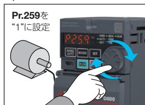
モータが接続されて停止中であることを確認した後、Pr.259に“1”を設定します。
