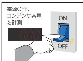
電源OFF、コンデンサ容量を計測
