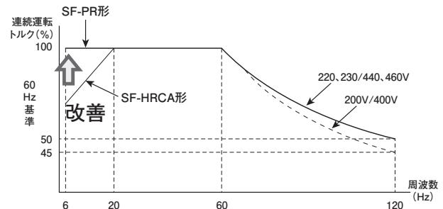
60Hz トルク基準とは、60Hz 運転時のモータ定格トルクを100%トルクとして示しています。
