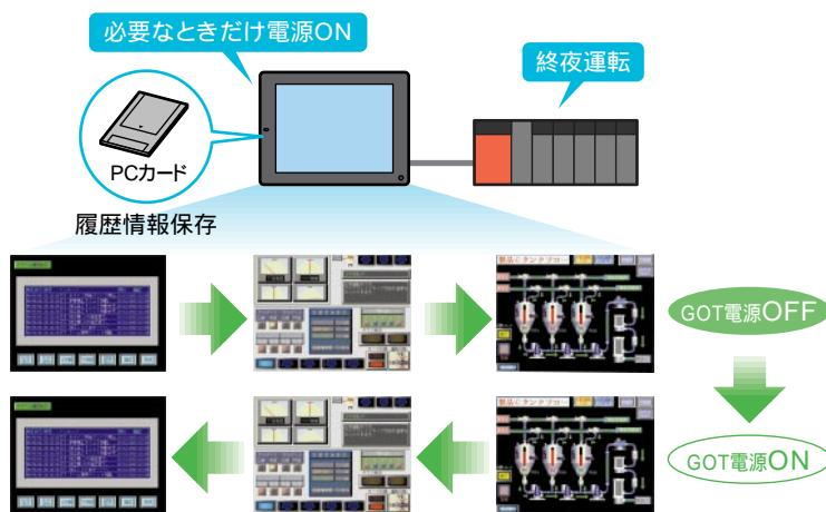
通常は、GOTの電源をOFFすると、切換え履歴情報が消去されますが、PCカードに履歴情報を保存することで、GOTの電源をOFF ONした場合でも、OFFする前の画面に戻ることができます。( 3 )
