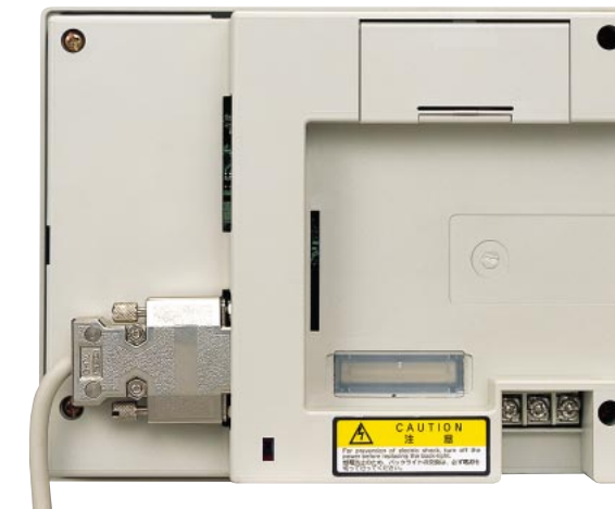
背面( ストレートコネクタケーブル接続時 )
