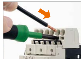
電線を奥まで差し込む ※電線が止まるまで差し込んでください。
