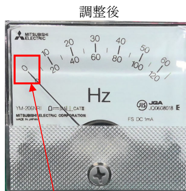
0Hz を指すように調整 (インバータ電源 OFF 時の針の位置となります。)
