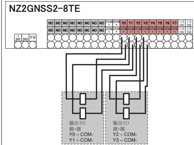
不支持源输出+漏输出，因此应将配线更改为源输出+源输出。
