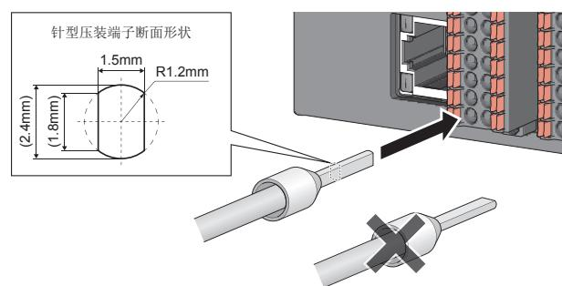
压装端子应更改为对应电线的线径的推荐棒型压装端子。
