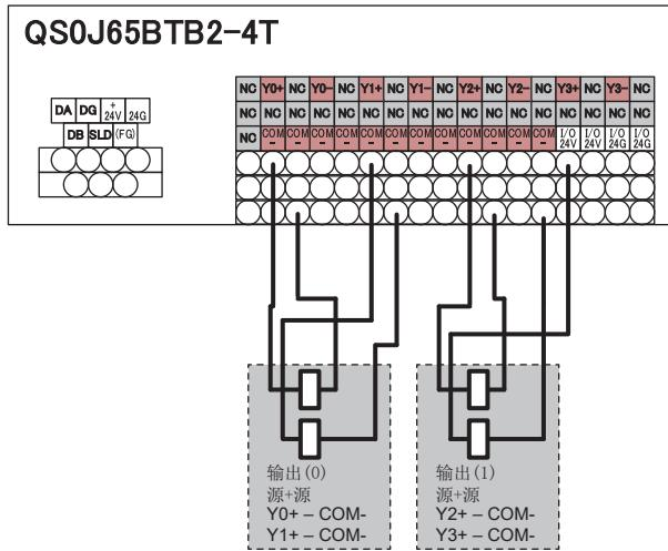
在源输出+漏输出中，冗余输出时：最多4点。
