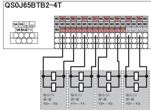
在源输出+源输出中，冗余输出时：最多可连接4点。
