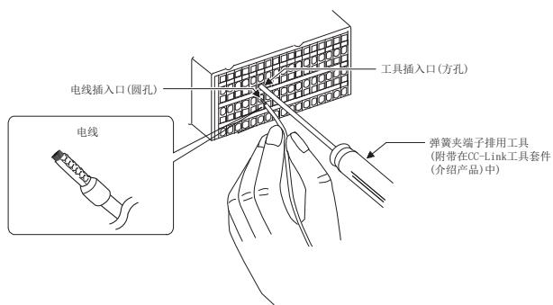
已有产品中使用的棒型压装端子无法使用于替换产品的CC-Link IE TSN带安全功能远程I/O模块。
