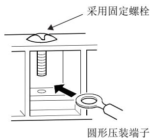
已有产品中使用的圆形压装端子无法使用于替换产品的CC-Link IE TSN带安全功能远程I/O模块
